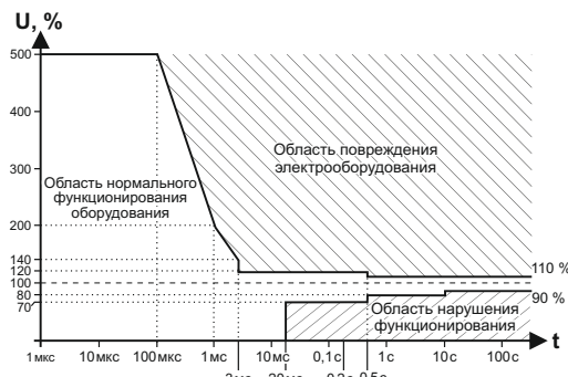
Рис. 1. Кривая работы электрооборудования ITIC (CBEMA), ( http://www.home.agilent.com/upload/cmc_upload/All/1.pdf?&cc=UA&lc=eng ).
